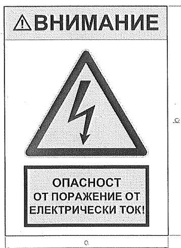
Фигура 2 - Табела „Внимание! Опасност от поражение от електрически ток!“
